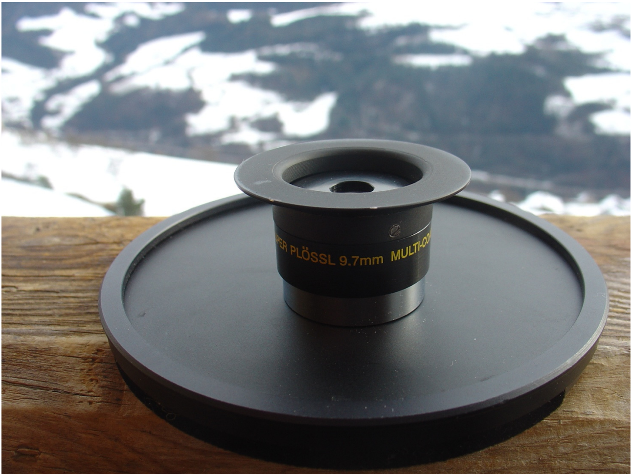
Okular mit Adapter und abgedrehter Einsteckhülse (für eine ev. Filterverwendung)
